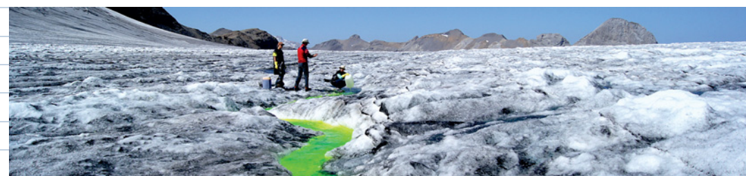
Abb. 6: Untersuchung der Abflusswege auf dem Plaine-Morte-Gletscher mit Markierversuchen (Foto: Flurina Schneider)
